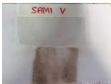
Figura 4.4 – Sistema geocomposito SAMI “V”
