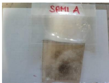
Figura 4.2 – Sistema geocomposito SAMI “A”
