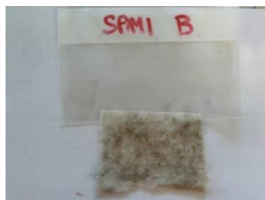
Figura 4.3 – Sistema geocomposito SAMI “B”
