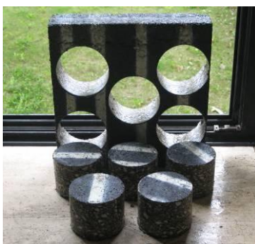
Figura 1.3 – Provini cilindrici e prismatici ricavati da piastre bistrato
