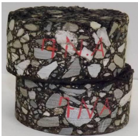
Figura 2.4 – Provino ASTRA al termine della prova
